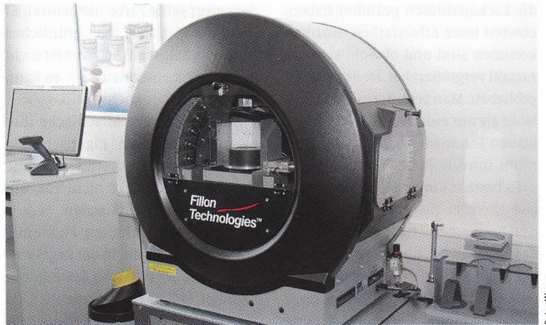
„Daisy Wheel“ soll den Lackmischprozess revolutionieren – der Automat mischt Farbtöne vollautomatisch.
