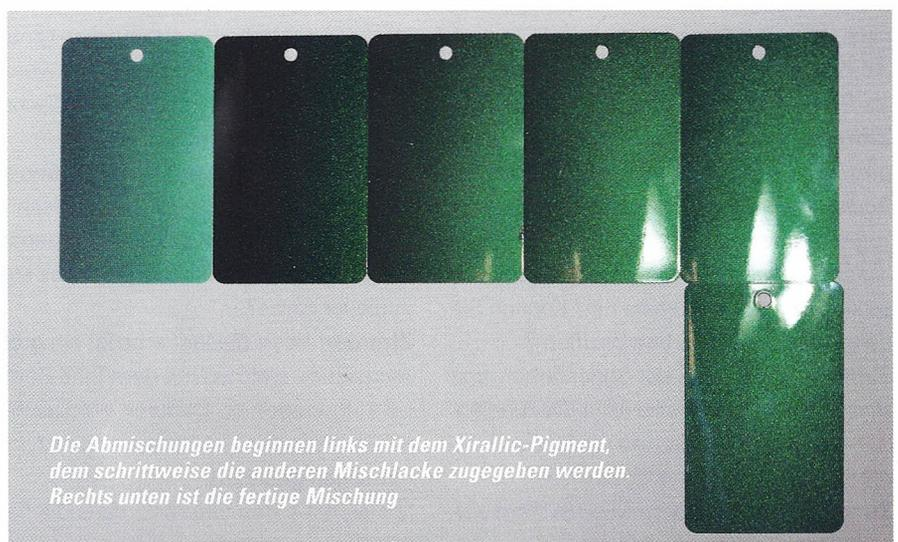
Die Abmischungen beginnen links mit dem Xirallin-Pigment, dem schrittweise die anderen Mischlacke zugegeben werden. Rechts unten ist die fertige Mischung
