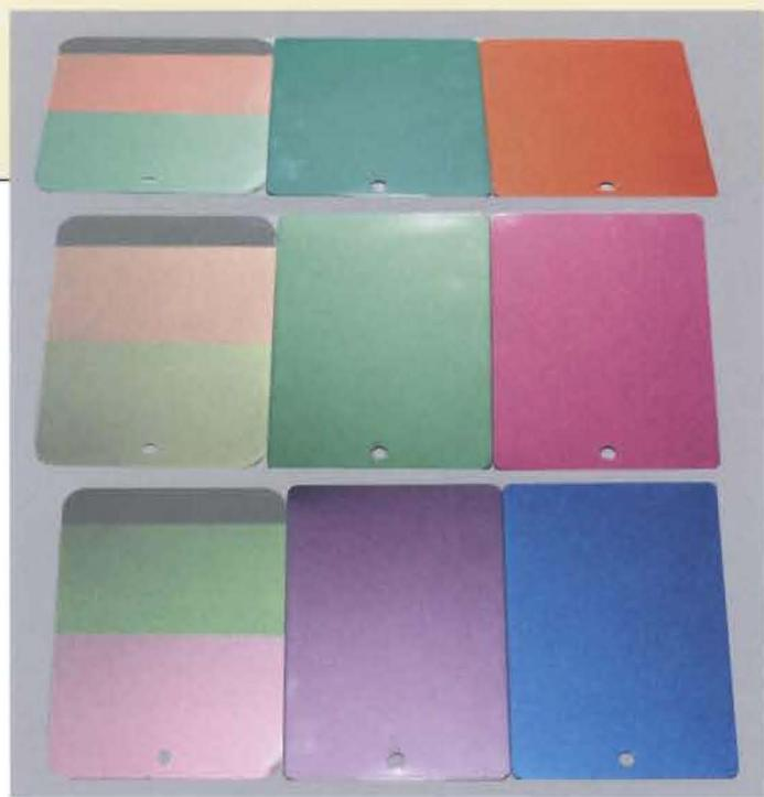
*Ganz schön durchgeknallt: Colorstream und ChromaFlair-Pigmente unter schräger Beleuchtung (oben), unter mittlerem Beleuchtungswinkel (Mitte) und unter steiler Beleuchtung (unten). Unter jedem Beleuchtungswinkel erscheinen diese Pigmente in einer anderen Farbe*
