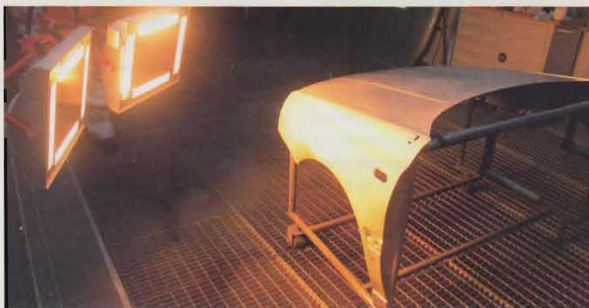
Die mobile Infrarot-Trocknung erweist sich bei kleinen Flächen als ideale und schnelle Methode zur Trocknungsbeschleunigung
