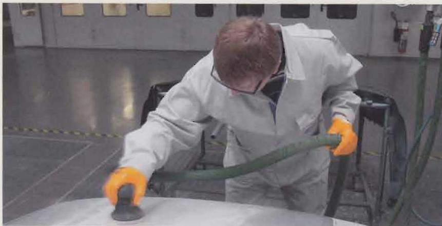
Der maschinelle Trockenschliff der Altlackierung liefert eine gleichmäßige Schlieffläche
