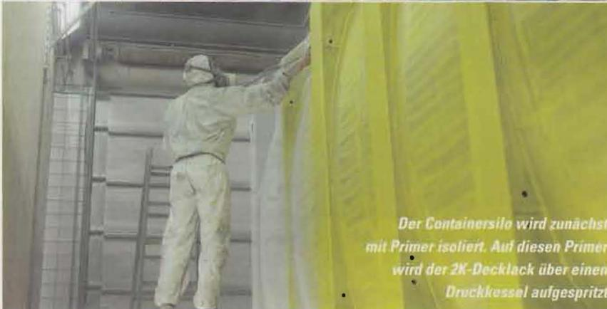
Der Containersilo wird zunächst mit Primer isoliert. Auf diesen Primer wird der 2K-Decklack über einen Druckkessel aufgespritzt
