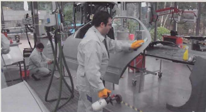
Die Reinigung der geschliffenen Stellen erfolgt hier mit einer Pump-Flasche und Mikrofaser Tuch
