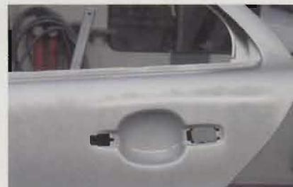
Eine Altlackierung wird komplett trocken mit der Maschine angeschliffen
