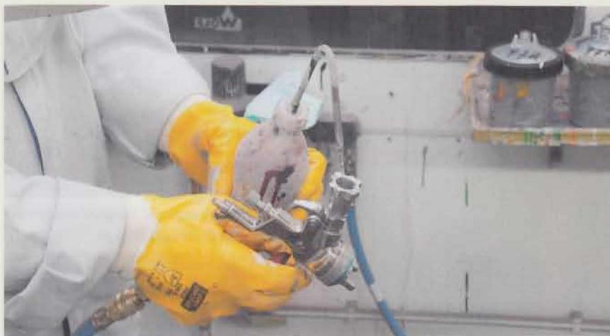
**Sauberkeit und Reinigung ist in allen Bereichen der Lackierung angesagt. Hier wird der Farbkanal der Spritzpistole nach Abnahme des Farbbeckers gesäubert**
