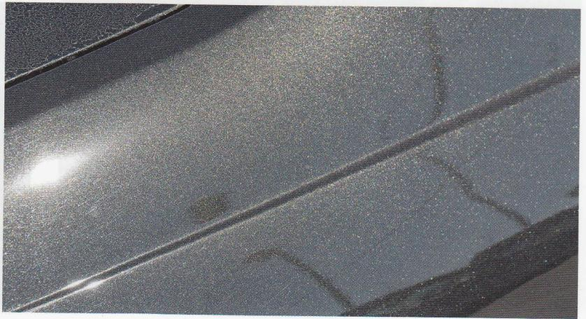
**Neben der Farbe sind es Effektelemente wie Aluminiumpartikel, die den Eindruck beeinflussen; Eine Farbmessung kann sie herkömmlichen Methoden nicht erfassen**
