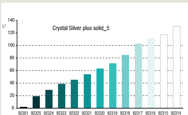
Abb. 7 // In der gleichen Mischreihe nimmt die Helligkeit kontinuierlich zu, wenn der Anteil an weißem Interferenzpigment steigt. Ein Wendepunkt ist nicht zu erkennen.
